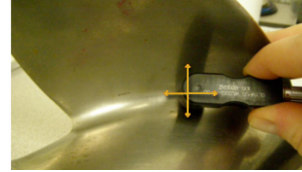
Ejemplo de escaneo en una hélice como parte de un ensayo por corrientes de Foucault
